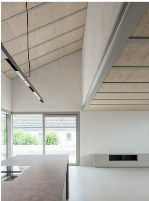
Die Erweiterung und Umstrukturierung eines Einfamilienhauses zum gesunden, modernisierten Wohnhaus setzt auf Stahl als systematische Tragstruktur mit zementstabilisierten Lehmprodukten als Füllung und Fassade. So sind die Zwischenwände mit komprimierten Lehmsteinen gemauert und die Aussenwandkonstruktion mit Hanflehmplatten innen beplankt, jeweils mit handelsüblichen Lehmdeckputzen versehen. Auch die lose in Stahlträger ein-
