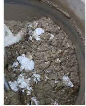
Heissmörtel im Mischer: Stöckkalk, Sand, Splitt, Trass, Lehm und Wasser
