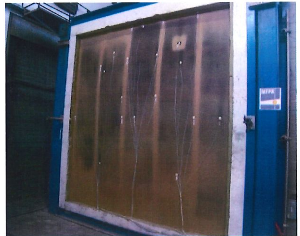
Bild A6.14: Ansicht der feuerabgewandten Seite nach Beendigung der Prüfung.
