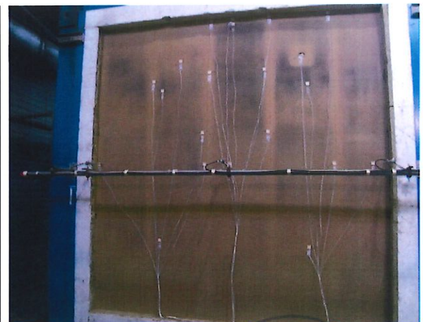
Bild A6.12: Prüfminute 57, deutliche Verfärbungen auf der Oberfläche der feuerabgewandten Seite.
