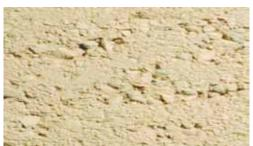
Aus Stampflehm — auch Pisé genannt — werden tragende oder nichttragende Massivwände hergestellt. Der erdfeuchte Stampflehm wird in vorgängig gestellte stabile Schalungen eingefüllt und verdichtet. Für eine optimale Verdichtung weisen die Schichten eine Höhe von jeweils etwa 10 bis 15 cm.
