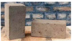
Lehmsteinwände werden aus ungebrannten Lehmsteinen mit Lehmmörtel in üblicher Mauerwerkstechnik errichtet. Lehmsteine sind im Vergleich zu Backsteinen nur getrocknet (Tonprodukte müssen zum Erlangen ihrer Stabilität im Ofen gebrannt werden). Es gibt sie als Volllehmsteine oder auch als Strangpressprodukte (gelocht), sogenannte Grünlinge.
