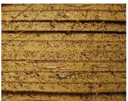
Leicht-Lehmbauplatten sind Trockenbauplatten für den Innenausbau. Dank des guten Sorptionsvermögens und der damit verbunden positiven Wirkung auf das Raumklima ist sie das ideale Ausbaumaterial im modernen Leichtbau.
