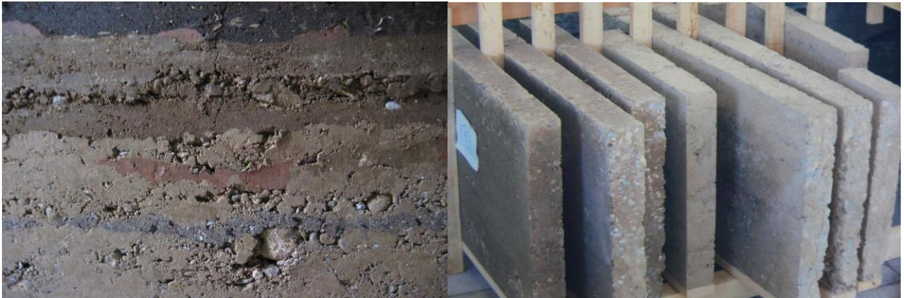
Benno Reber: Entwicklung von 8 cm starken Stampflehmelementen für den Einsatz als Vorsatzschalen und als Raumteiler. Vorgabe ist, dass die Elemente von Hand verschoben und versetzt werden können.
