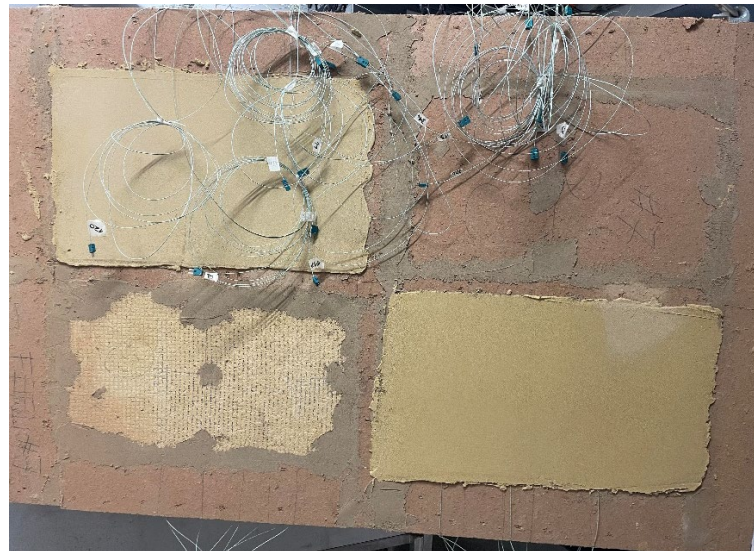
Abb. 3: Typischer Probekörper mit vier unterschiedlichen Lehm- und Holzbauplatten für die Brandversuche
