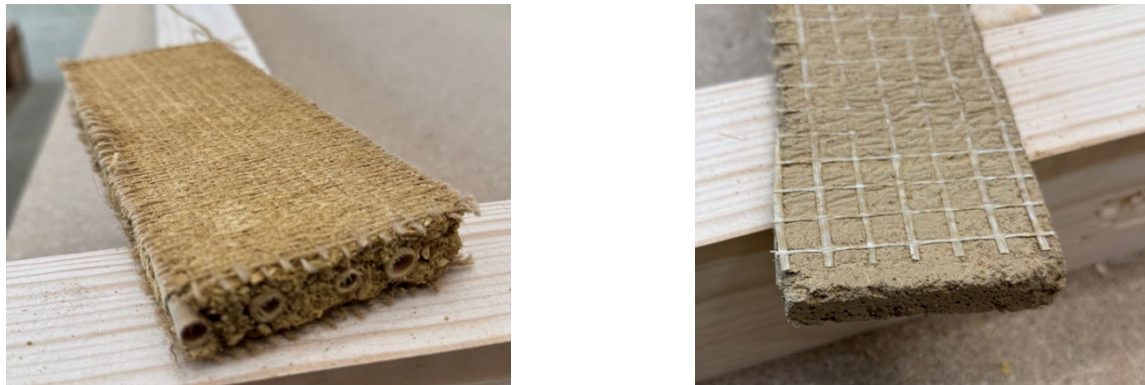
Abb. 1: Unterschiedlicher Aufbau von zwei Lehmbauplatten
