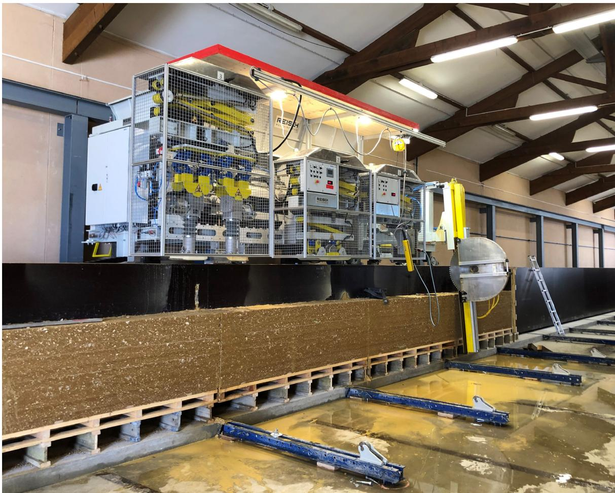
**Feldmaschine zur Erstellung von Lehmelementen aus Bodenaushub**
