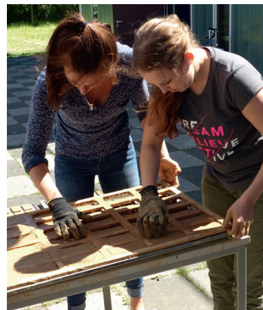
Abb. 3 Herstellen von Lehmfliesen für den Bau eines katalanischen Gewölbes auf dem Campus der HS Wismar im Rahmen der 3. Tage des ökologischen Bauens 2016
