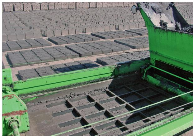
her bei einer Jahresproduktion von 100.000 Adobes. Der „Adobe Man“ verfügt über 12 Jahre Berufserfahrung. Die Arbeits- und Treibstoffkosten ergaben bei einer einmaligen Prüfung: Für 1.000 Ziegel werden 26 Arbeitsstunden und 10 Liter Diesel benötigt. Die Sonneneinstrahlung zieht etwa 3 Liter Wasser aus einem Stein im Trocknungsprozess. Es werden nur „natürliche“ Steine ohne Stabilisatoren hergestellt. Sie werden für US\$ 2,00 das Stück verkauft.
