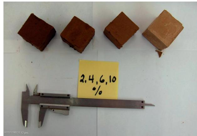
Tabelle 1: Tests mit Kalkstabilisatoren in Adobes
