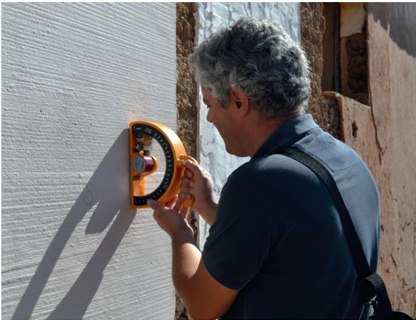
Abb. 3 Härtetest mit dem Schmidt Pendelhammer auf vorgemischtem, kommerziellem Putz.
