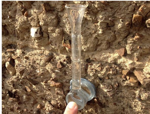
Abb. 4 Wasserabsorptionstest mit Karstenröhre auf einer alten Stampflehmwand
