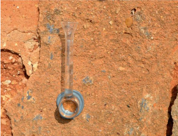
Abb. 1 Karstenröhren zur Wasserabsorptionsmessung auf altem Putz
