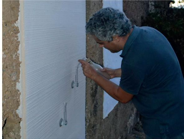
Abb. 2 Wasserabsorptionsmessung mit Karstenröhren auf vorgemischtem, kommerziellem Putz
