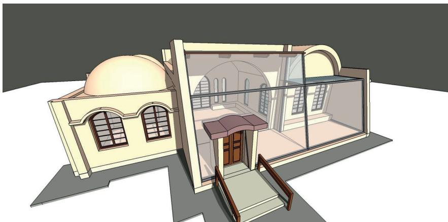
Die Passive Solarnutzung ist grundlegend für den REHP Entwurf, welcher folgende Dinge in Betracht zieht: Direkter Wärmegegewinn, Gewächshausprinzipien, Orientierung, vorgesehene Überstände, wenig oder enge Fenster auf der Nordseite und natürliche Verschattung sowie zusätzlich die Verwendung von Speichermasse aus Lehm für die Wandkonstruktion und die Wärmespeicherung. Dies wird auf natürliche Weise den Innenraumkomfort gewährleisten.
