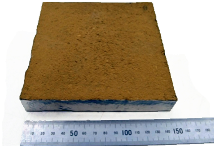
Abb. 3 Lehmprobe mit Feuchtigkeitspufferung
