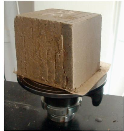
Aufgrund der Ergebnisse der Druckfestigkeitsuntersuchungen wurde der hydraulische Binder MULTIBAT als Beimischung bestimmt für die Erhöhung der statischen Parameter der Lehm-masse und für die Verbesserung des Schutzes und die Erhöhung der Widerstandskraft der Bauteile beim Transport.
