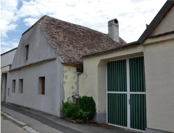
Abb. 10 keine materialgerechte Sanierung: EPS-Außen-dämmung eines historischen Lehmziegelbaus in NÖ
